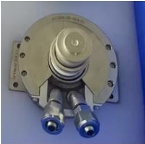
20 kW Magnetron 0,915 GHz ohne Elektromagnet
