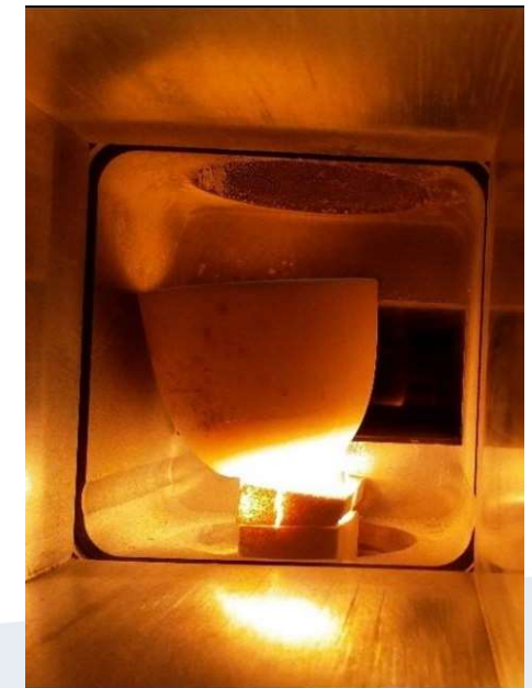
Aufschmelzen von Glas mittels Mikrowellenstrahlung, GWA, Dr.-Ing. R. Behrend
