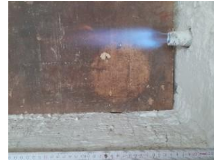
Brenner: im Betrieb mit 100 % Erdgas
