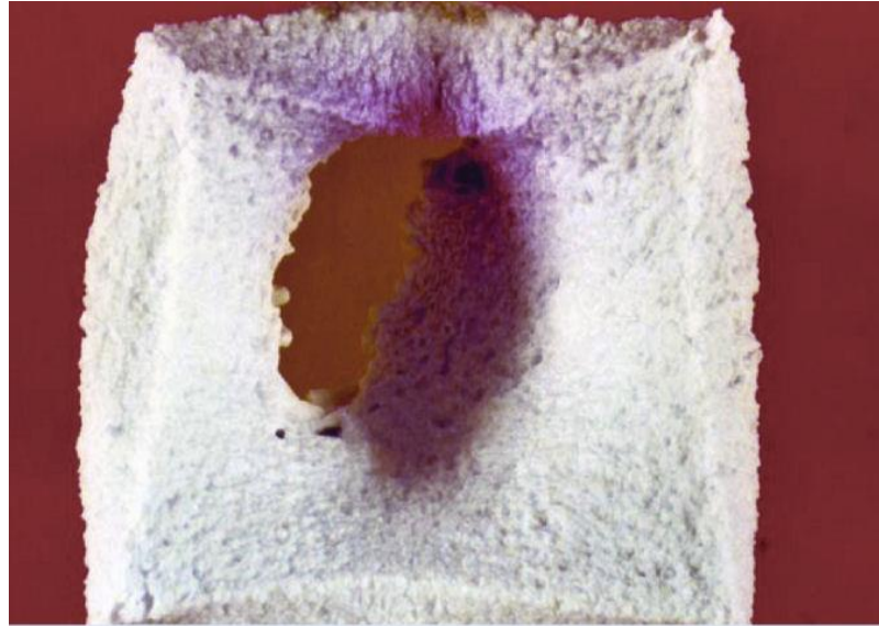
Feuerleichtstein JM 30 nach Alkalikorrosionstest 1500°C/12 Stunden
