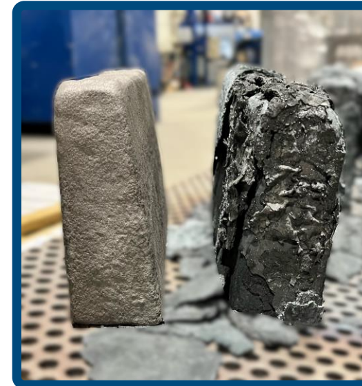
Zwei Gussteile links ohne und rechts mit Verzunderung durch eine Wärmebehandlung
