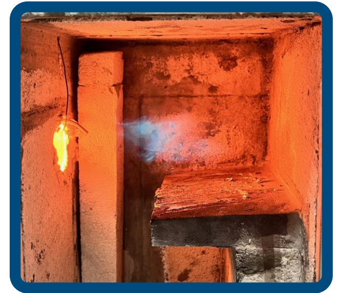
Sichtbarer Heißgasjet des UHT-Thermo-Jets
