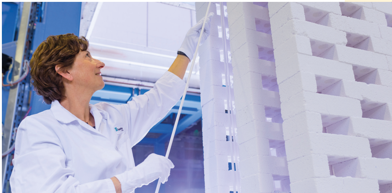
Abbildung 3: Vorbereitung keramischer Nanofiltrationsmembranen für die Sinterung. © Fraunhofer IKTS
