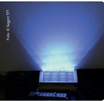
Labormuster UV-LED-Array mit polymerkeramischem Reflektorrahmen
