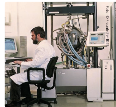
Bestimmung der Inertfestigkeit von Hochleistungskeramiken
